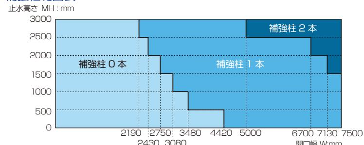
※開口高さが3000mm以下の場合は、開口高さが最大止水高さとなります。(シャッターケースの水没不可)
