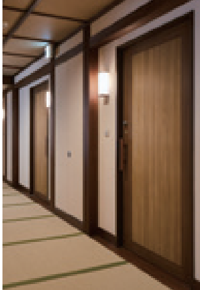
高齢者集合住宅向け玄関ドア（特定防火設備） 「ヴァリフェイスAi」 引戸でありながら遮音性能・気密性能を有し、特定防火設備として防火区画に使用できる遮炎性能も備えています。 ○用途：玄関入口、客室入口
