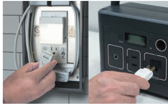
コンセントを抜き、車載コンセントやポータブル電源につなぎます。
